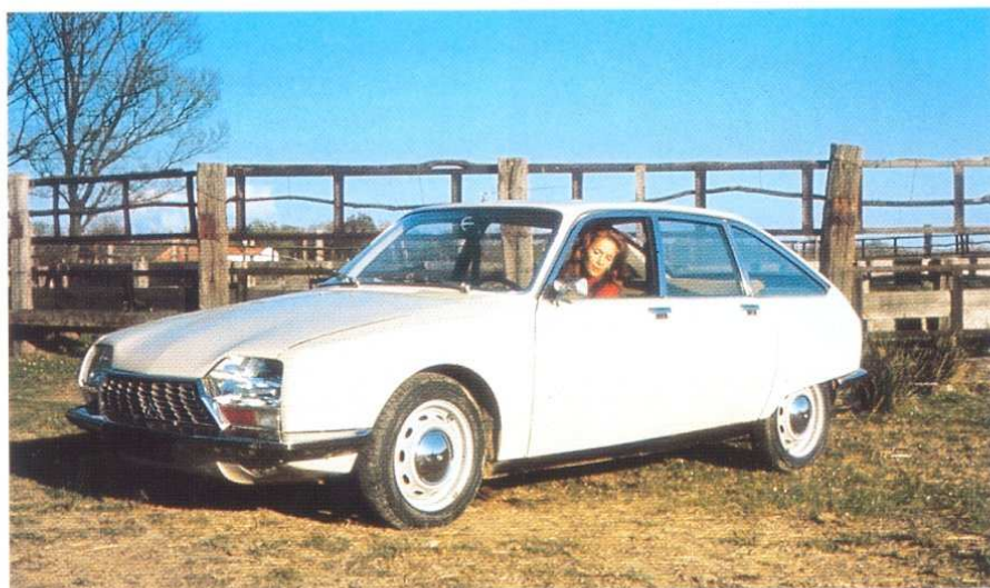
Millésime 1971, premier modèle de GS à moteur 1 015 cm 3 . Notons la grille de la calandre et les petits enjoliveurs de roues.
