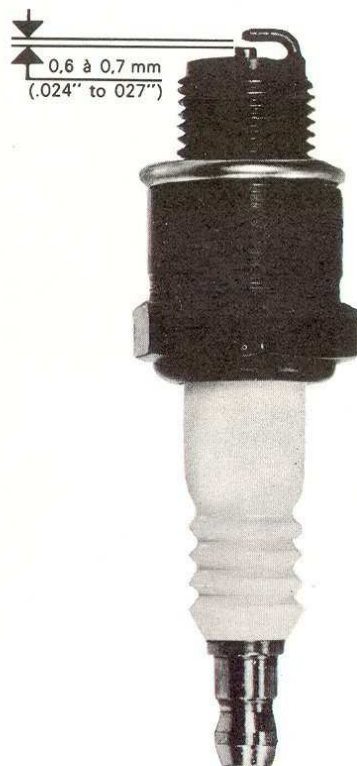
Fig. 36—Plug electrode gap
